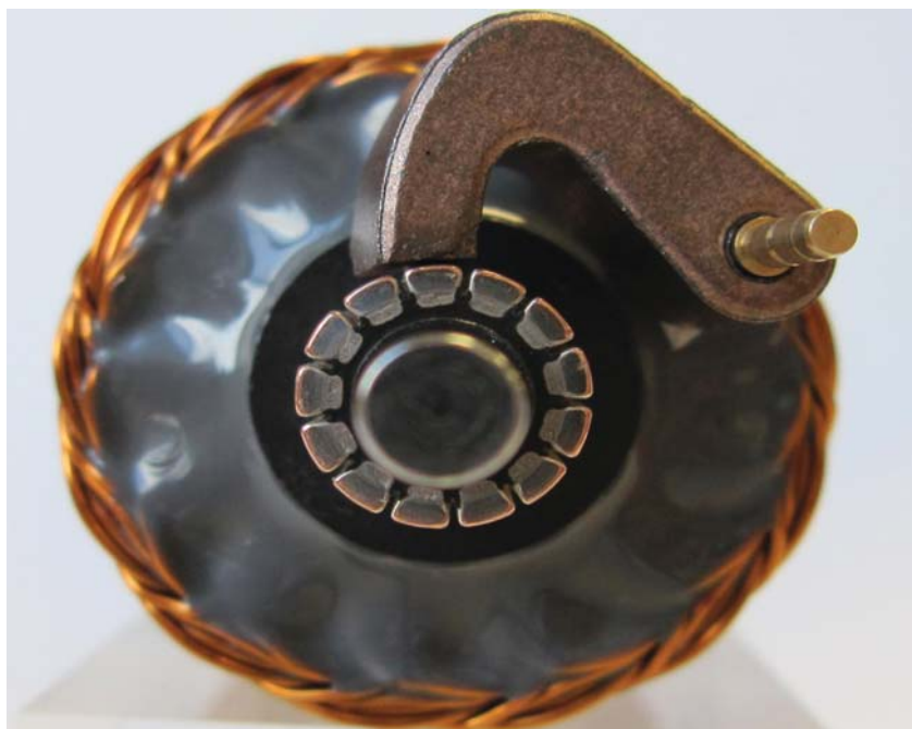
Conjunto escobilla-colector o conmutador, necesario para que el motor DC gire. El colector de 13 delgas facilita la regulación y prolonga la vida en servicio del motor de corriente continua.
