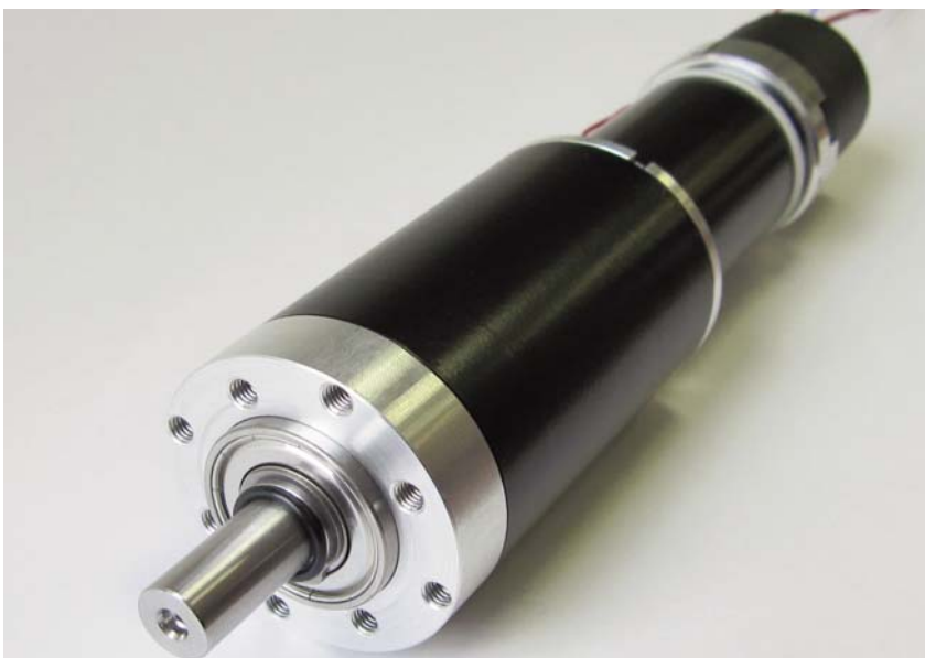
Motor de corriente continua de 150 W con reductora planetaria y freno de seguridad: al faltar la corriente se acciona el freno, para evitar accidentes.
