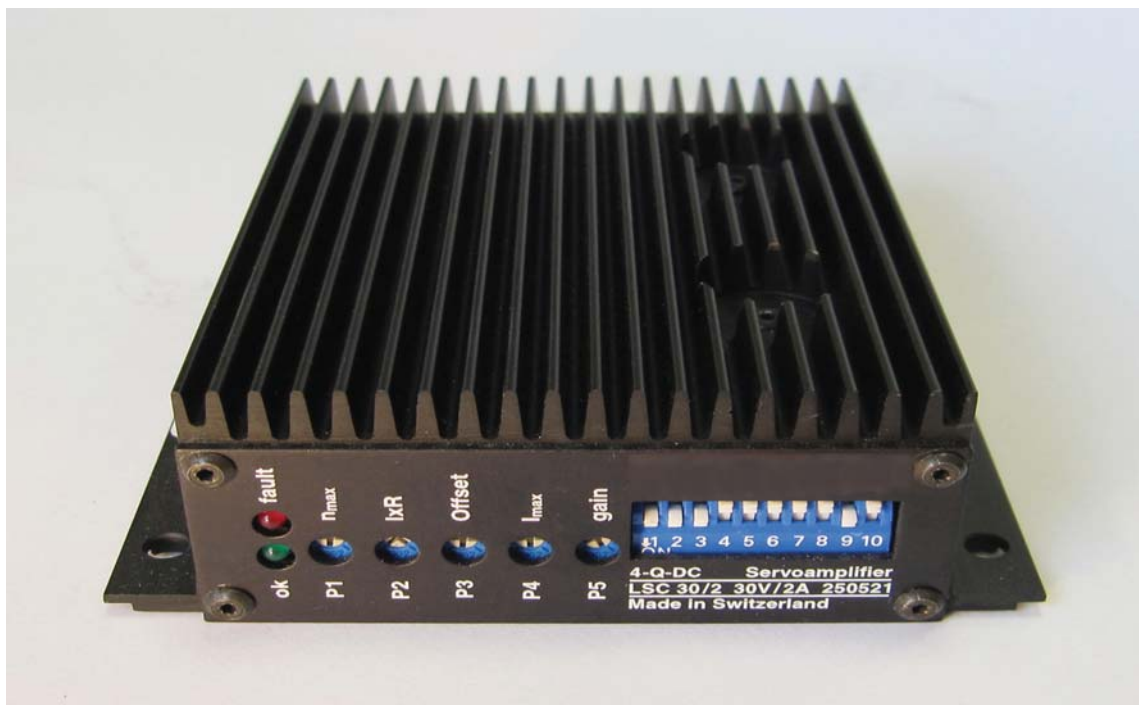
Servoamplificador de control de velocidad y corriente. Etapa de salida lineal de 2 A. Bucle cerrado por encoder o tacodinamo.
