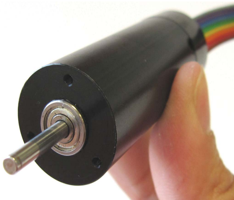
Micromotor Brushless DC de 22 mm de diámetro. La ausencia de escobillas en la conmutación prolonga la vida útil del motor. Sin embargo necesita una electrónica de control de la conmutación
