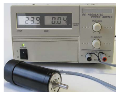
Fuente de alimentación dc de laboratorio. El voltaje se puede regular de 0 a 30 V y la corriente de 0 a 3 A
