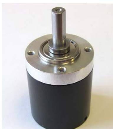
Reductora planetaria de 2 etapas, para motor pequeño. Acoplada mediante un piñón al eje del motor, reduce la velocidad de giro y aumenta el par en proporción a su relación de reducción.
