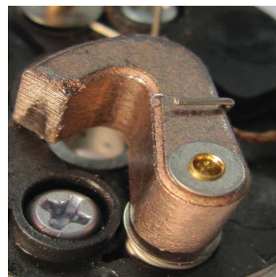
Escobilla de 50% grafito, y 50% cobre. Se aprecia el inicio del desgaste por su interacción con el colector
